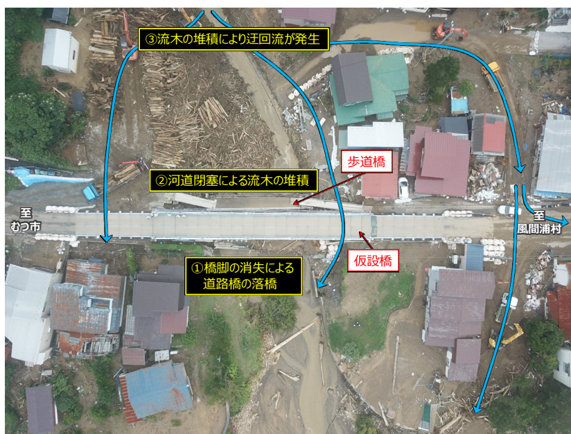
図 3.11 調査結果から推定した被災の過程
